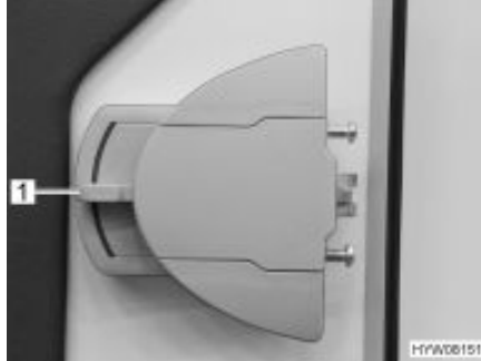
Fig. 30 Door lock, inside
